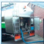
Messsysteme von GEA Diesel stehen für eine exakte, manipulations sichere und amtlich zugelassene Mengenerfassung flüssiger Produkte auf Fahrzeugen, sowohl im Annahme- als auch im Ausgabebetrieb. Eine integrierte Datenerfassung und Probenahmeverrichtung sowie GPS-Positionsbestimmung runden das „mobile Managementsystem“ ab.
